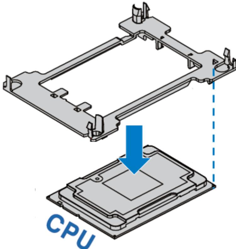
步骤 2：散热器标签上“1”的位置与 Clip 上三角标识对应，然后将散热模组上的定位孔与和 Clip 垂直对应，按压组装在一起。
