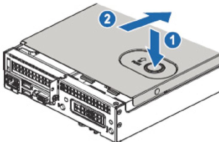
4. 按照如下方式拆卸主板上的导风罩。
