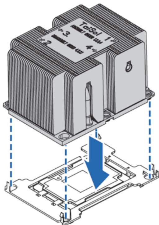
步骤 3：将组装好的散热模组垂直安装到 CPU 底座上，散热模组标签上的数字 1 的位置与主板 CPU 底座上三角标识对应；然后按照标签所序 1、2、3、4 顺序锁附螺丝。
